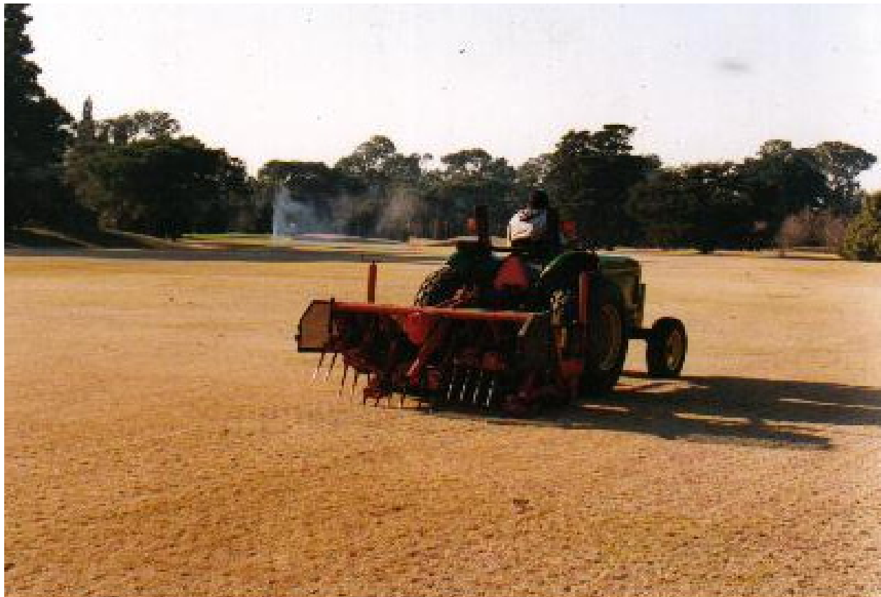
Figura 19: Realização da operação de aração profunda com pino cheio.
