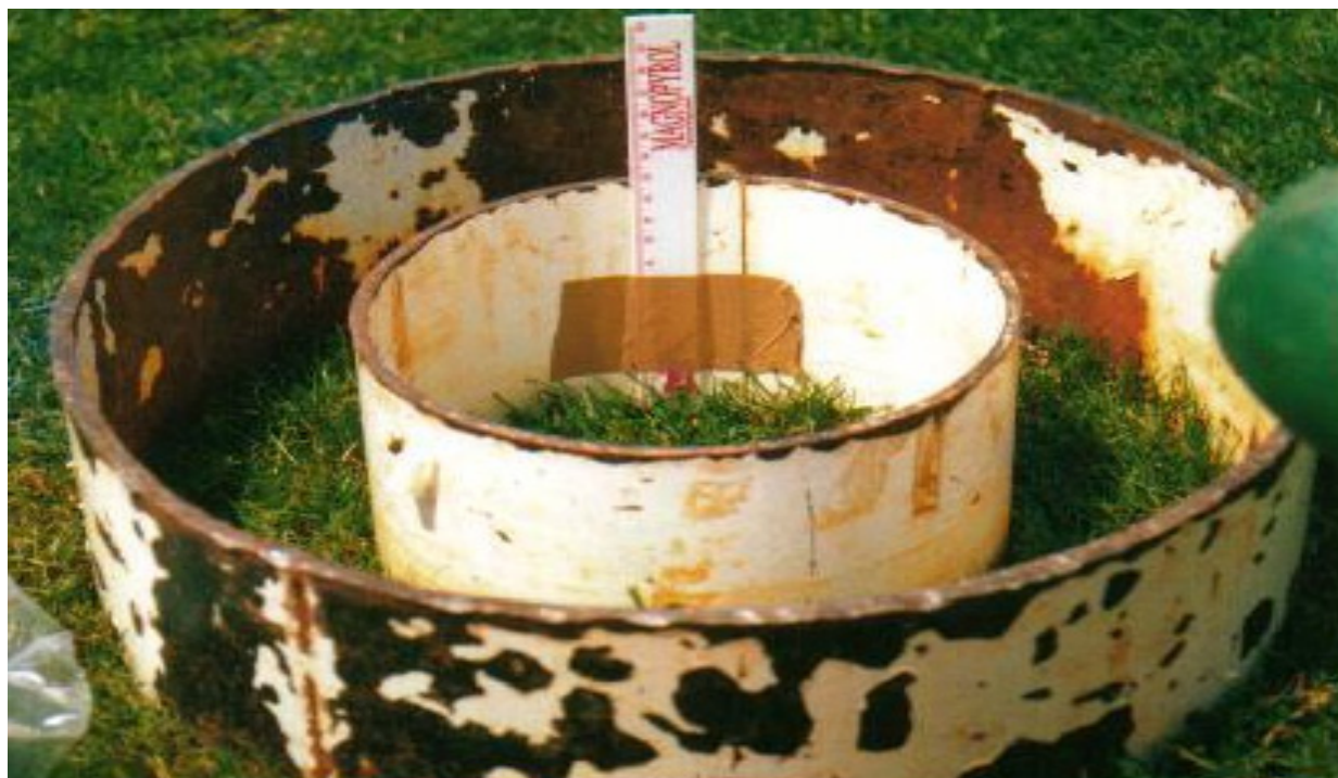
Figura 13: Infiltrômetro de anel duplo usado durante teste de infiltração.
