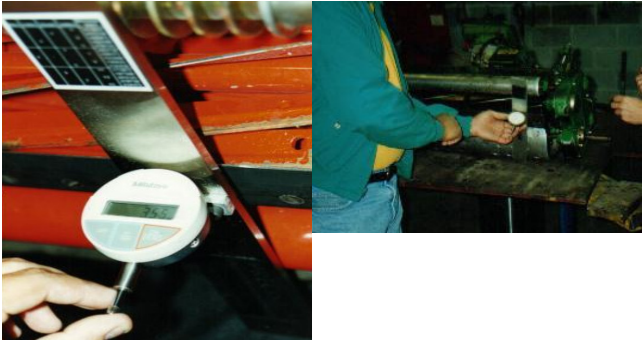
Figuras 7 e 8: Aparelho Accu Gage usado na calibração de lâminas de corte.
