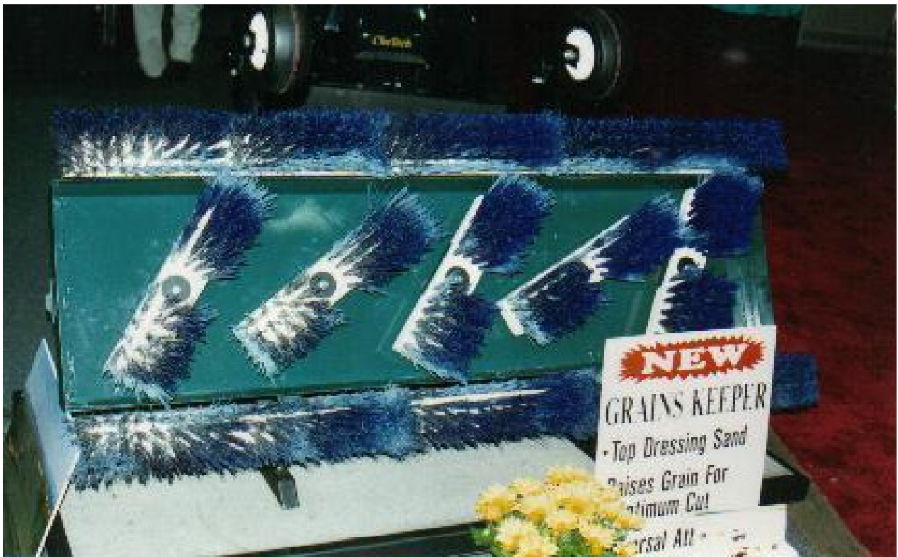
Figura 25: Escovas de pêlo utilizadas em máquinas de top dressing.
