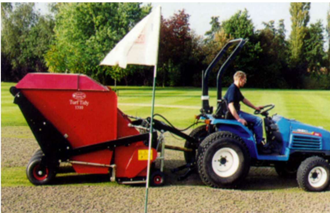
Figura 9: Operação de recolhimento de resíduos da aeração mecânica.
