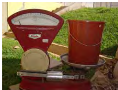
Figura 9. a – detalhe da presilha na extremidade do tapete; b – tapete preso nas duas extremidades; c – tapete pendurado para determinação da resistência; d – utilização da balança para determinação da massa necessário para o rompimento do tapete.
