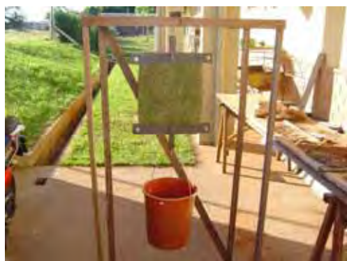
Figura 9. a – detalhe da presilha na extremidade do tapete; b – tapete preso nas duas extremidades; c – tapete pendurado para determinação da resistência; d – utilização da balança para determinação da massa necessário para o rompimento do tapete.
