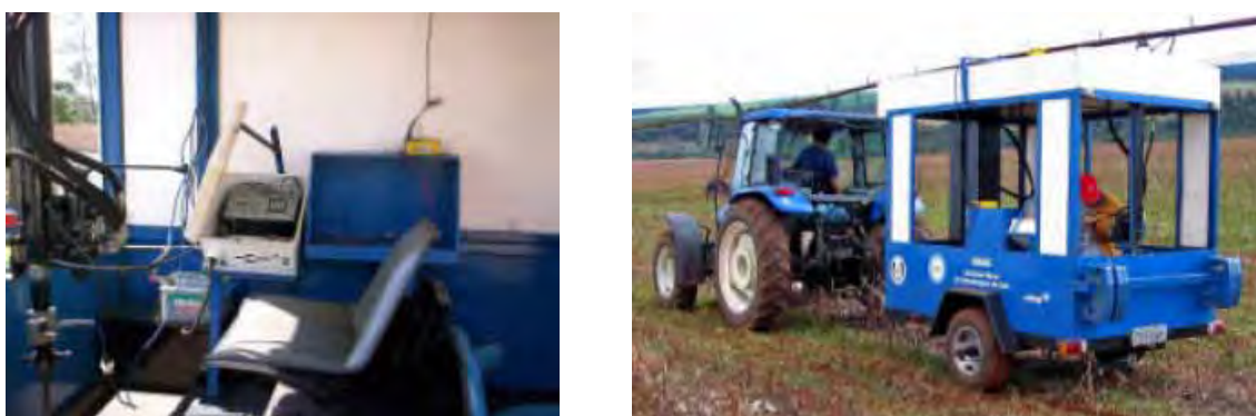
Figura 11. Unidade Móvel de Amostragem do Solo (UMAS) utilizada para determinação da resistência mecânica do solo a compactação.
