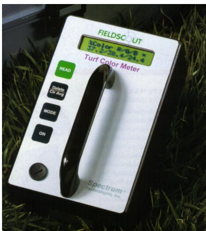
Figura 9. Medidor de coloração verde do gramado Field Scout TCM 500 Turf Color Meter.
