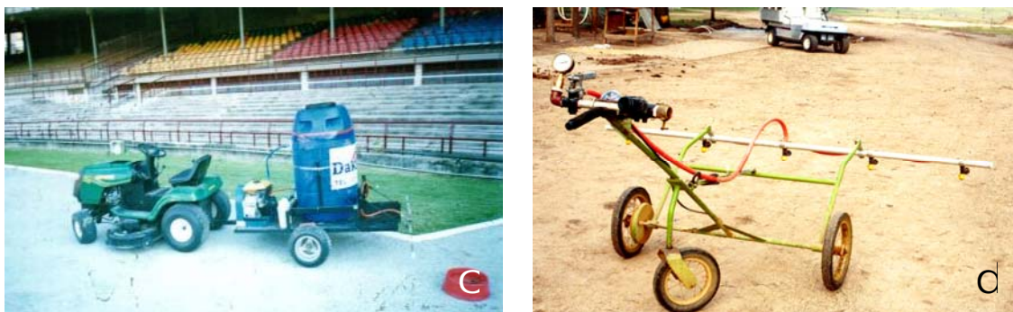
Figura 1. Pulverizadores adaptados para aplicação de herbicidas em gramados: a – pulverizador costal e barra de pulverização adaptados em um quadro de bicicleta; b – tobata com carreta, tambores e barra de pulverização; c - mini-tractor com carreta, tambor e barra de pulverização; d – barra de pulverização adaptada com rodas (“carrinho aplicador”) que deve ser acoplada a uma mangueira conectada a um tanque.
