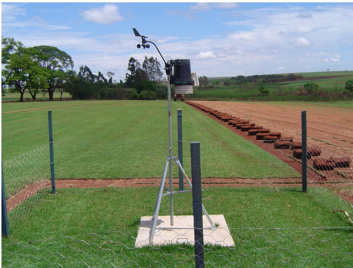
Figura 2 – Estação meteorológica automatizada modelo Vantage Pro 2 Plus.
