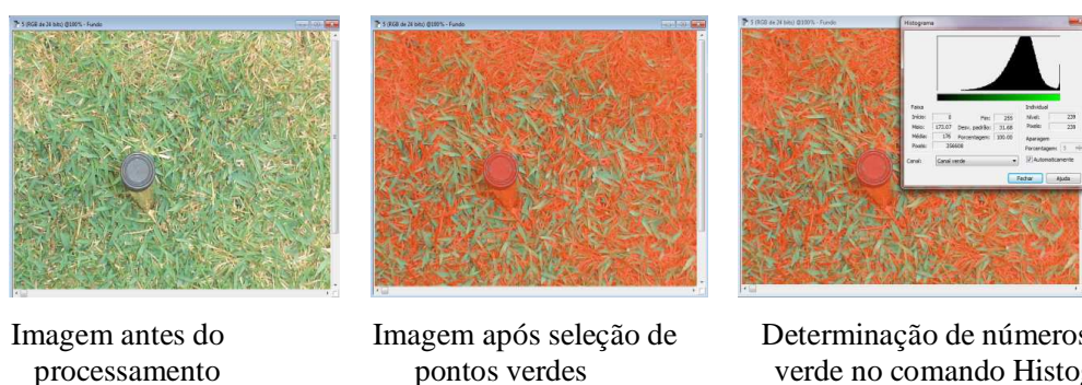
Figura 5. Análise da imagem digital para determinação da taxa de cobertura verde do solo (TCV).
