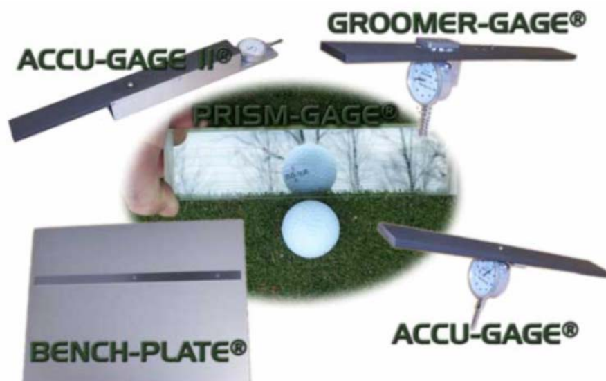
Figura 9. Accu-gage: aparelho utilizado para medir a altura de corte efetiva.
