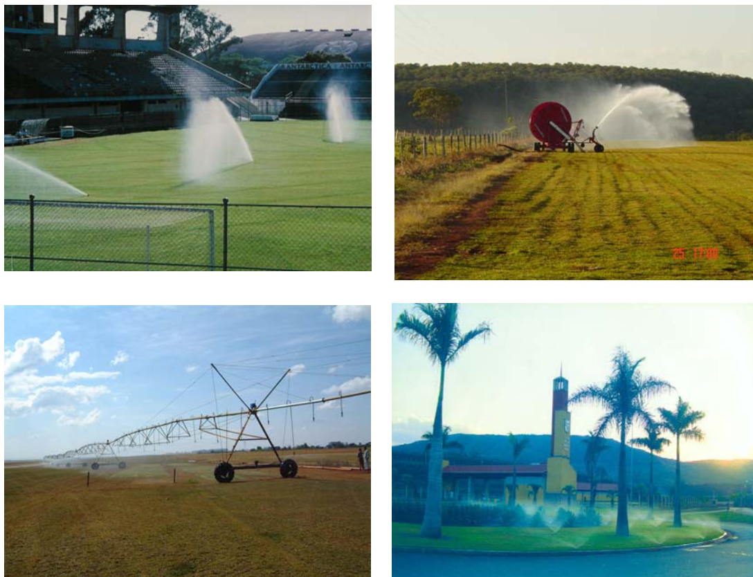
Figura 2. Diferentes tipos de sistemas de irrigação em diferentes gramados: a – irrigação por aspersão (aspersor retrátil) em campo de futebol; b - irrigação por canhão hidráulico em campo de produção de grama; c - irrigação por pivô central em campo de produção de grama; d – irrigação por aspersão em jardim.
