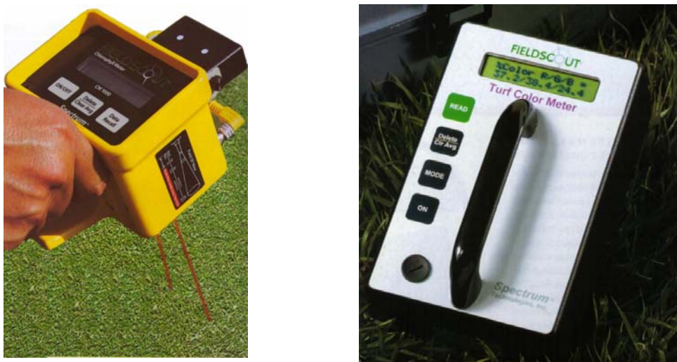
Figura 1 Aparelhos utilizados para medir a intensidade da coloração verde da folha, que pode ser um indicativo para a necessidade da fertirrigação nitrogenada.
