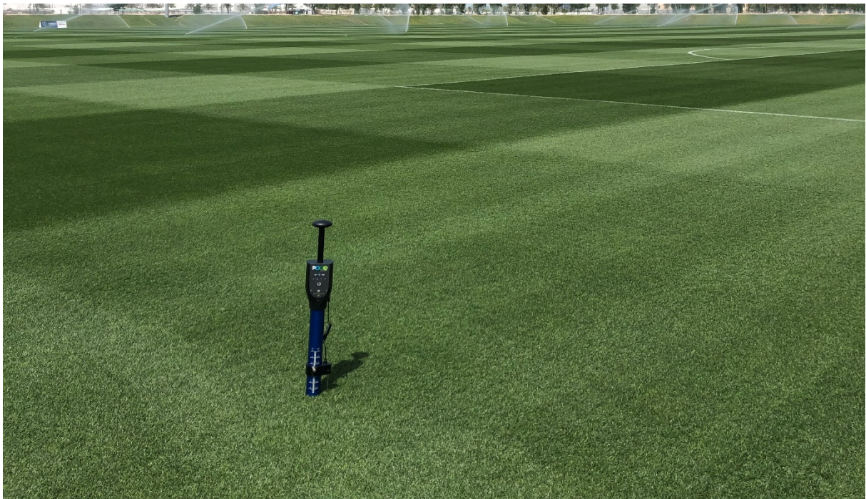
Figura 12. Medidor de umidade do solo, Lusail (Qatar), 2022.
